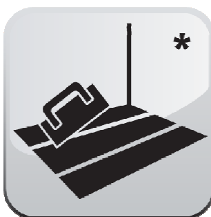
11. Wypełnić szczeliny dylatacyjne *
